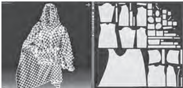
Рис. 3. Проведення декомпозиції одягу (формування 2D- конструктивних елементів), фіксація візерунків та аплікацій, їх розмір та місце знаходження
