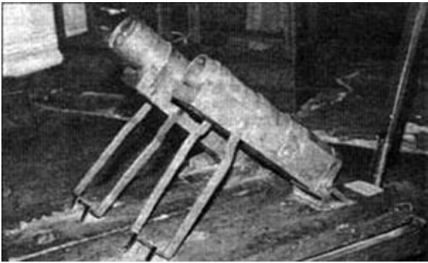
Міномети з гільз: спереду 3-дм (76-мм), позаду -107-мм.
