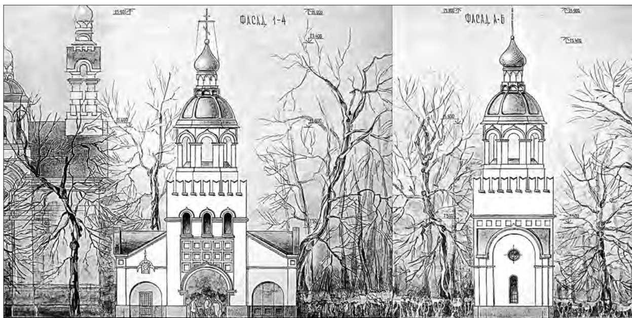
Рис. 7. Графічна реконструкція північного (зліва) та західного (справа) фасадів дзвіниці, кресленик О. Смолінської. 2006 р.
